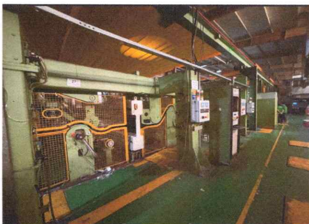
Hệ thống lô dẫn (Pull Ron)
