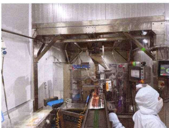
Hệ thống cân đóng gói túi nhỏ tự động cho trái cây đông lạnh lắp ráp tại Việt Nam
