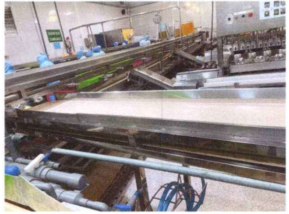
Hệ thống băng tải cho máy gọt vỏ Xoài tại Nhà máy Bình Long
