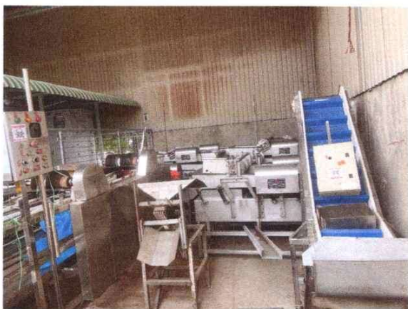
Máy bóc vỏ 1750*1100*1300 ( bao gồm con lăn cao su và con lăn bóc vỏ bằng thép không gỉ)
